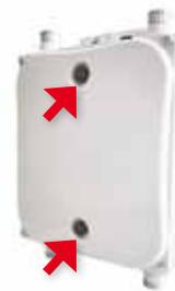
GORE® Screw-In Vents, integriert im Tower-mounted Amplifier von Radio Frequency Systems (RFS), verhindern das Eindringen von Wasser, das Korrosion und Kurzschlüsse verursachen kann.
