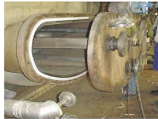
Mit dem ePTFE-Dichtungsband lassen sich insbesondere große Durchmesser zuverlässig abdichten
