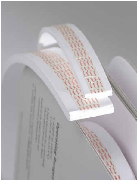
Die Montage von ePTFE-Dichtungsbändern erfolgt mithilfe eines Klebestreifens auf einer der flachen Seiten des Bandes
