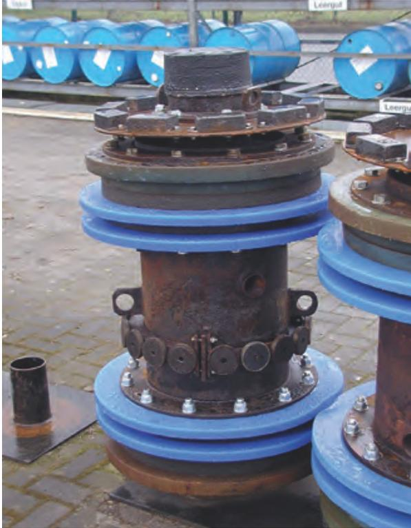
>>4: Reinigungsmolch für eine 28-Zoll-Rohrölpipeline mit Plastikmanschetten zur Reinigung (Bild: <https://commons.wikimedia.org/wiki/File:NWO-MolchPlastik2.jpg>)
