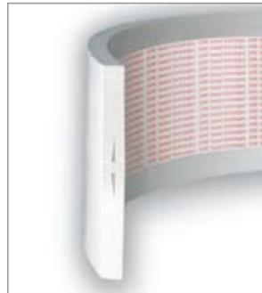
Das GORE® Dichtungsband Serie 1000 ist speziell auf die Herausforderungen in großen Stahl-Email-Apparaten ausgelegt und dichtet diese zuverlässig ab. Das zu 100 % aus expandiertem PTFE (ePTFE) gefertigte Dichtungsband ist sehr anpassungsfähig, chemisch inert und extrem widerstandsfähig gegen Kriechen, Kaltfluss und Schraubkraftrelaxation. Die von Gore entwickelte Seele sorgt für eine höchst zuverlässige Abdichtung auch bei geringer Flächenpressung.
