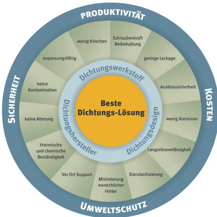
Bild 1: Herausforderungen bei der Dichtungsauswahl
